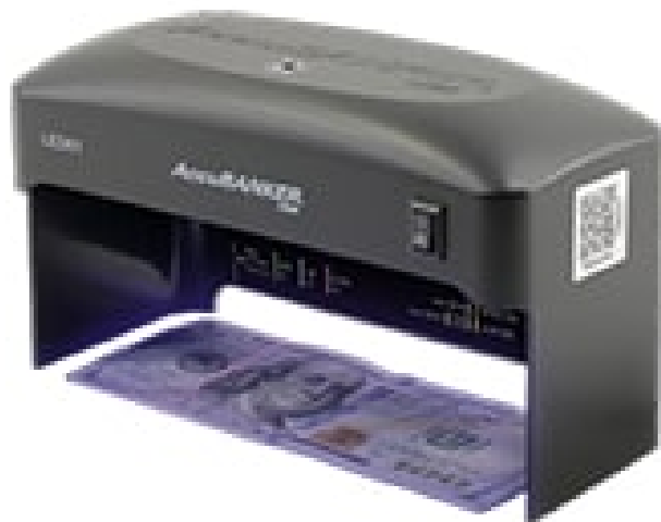
Jednoduchý tester bankoviek UV-A (365 nm)
